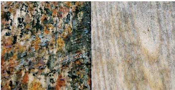
Struktur des Pilzbefalles auf hitzebehandeltem (links) und nicht-hitzebehandeltem (rechts) frischem Kiefernspilnholz nach zweiwöchiger Lagerung unter Folie in sehr feuchtem Klima
